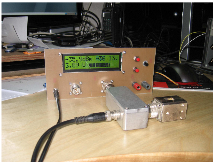
Mesure de la puissance (low) de sortie du FT897
