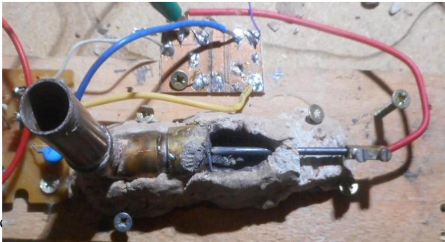
Eclateur en laiton refroidi par eau contenu dans tube cuivre (dia 12)
