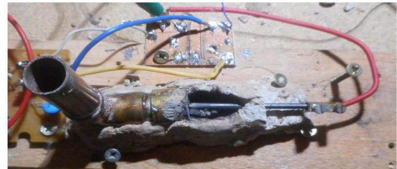
Éclateur laiton/graphite (graphite à la cathode)
