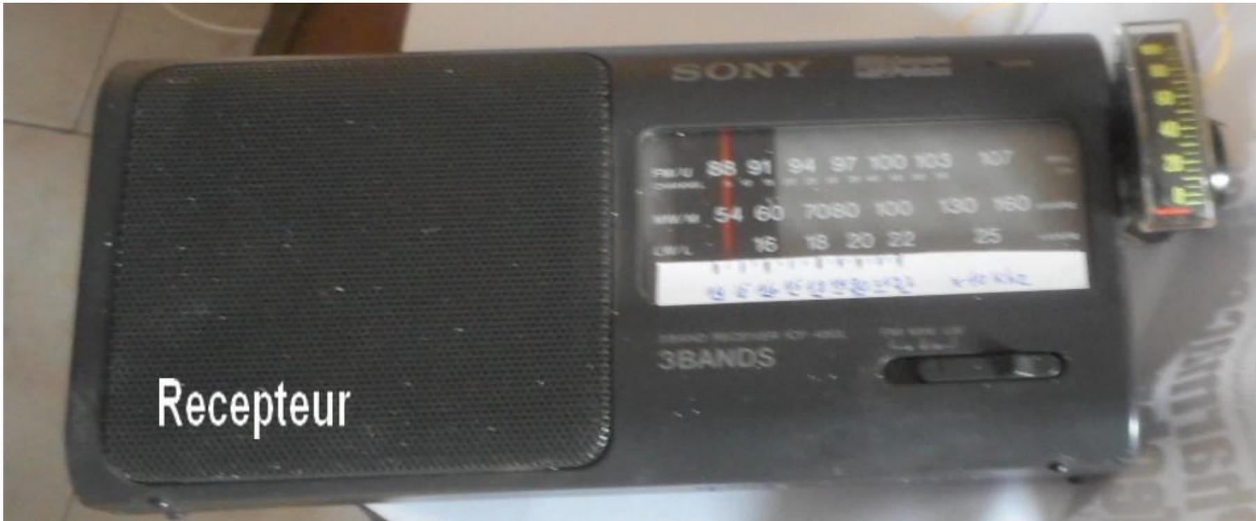
Recepteur PO/GO du commerce à cadre incorporé et Smetre sur détection
