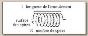
Si l'on plonge un noyau ferromagnétique à l'intérieur de la bobine, on multiplie son inductance par un coefficient µr appelé perméabilité du noyau. En enfonçant plus ou moins le noyau on pourra donc faire varier l'inductance entre deux valeurs limites.
