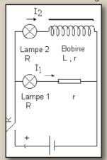
La bobine, qui possède un noyau magnétique afin d'augmenter le champ magnétique, a une résistance égale à celle du conducteur ohmique.
